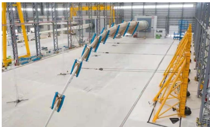
2021 年 5 月，由洛阳双瑞制造的国内最长的 102 米风电叶片在国家海上风电装备质量检验检测中心完成静力试验，这是我国首支依据国际标准开展的百米级风电叶片全尺寸试验。
